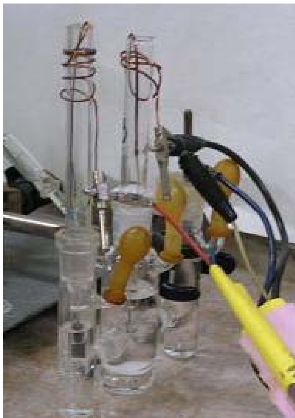
Rys. 3. Trójkomorowe naczynie elektrolityczne z elektrodą badaną, pomocniczą i odniesienia.
