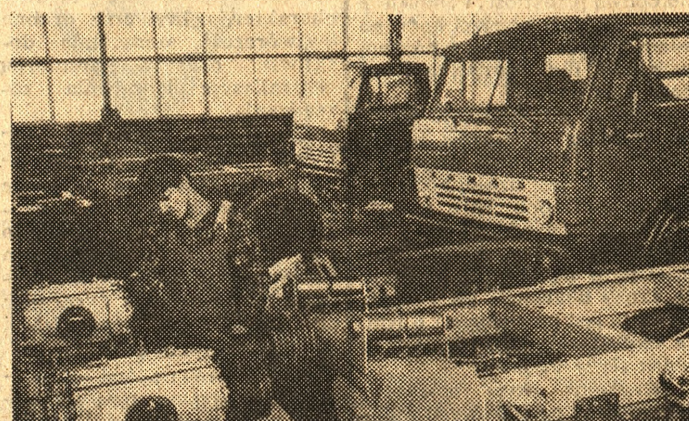
Zakłady „Presko” we Wschowie, woj. leszczyńskie, produkują urządzenia dla potrzeb gospodarki komunalnej. Wytwarzają tu sprzęt asenizacyjny i służący do zimowego utrzymania ulic. Na zdjęciu: przygotowywanie podwozi samochodowych do montażu zbiorników wozów asenizacyjnych.
