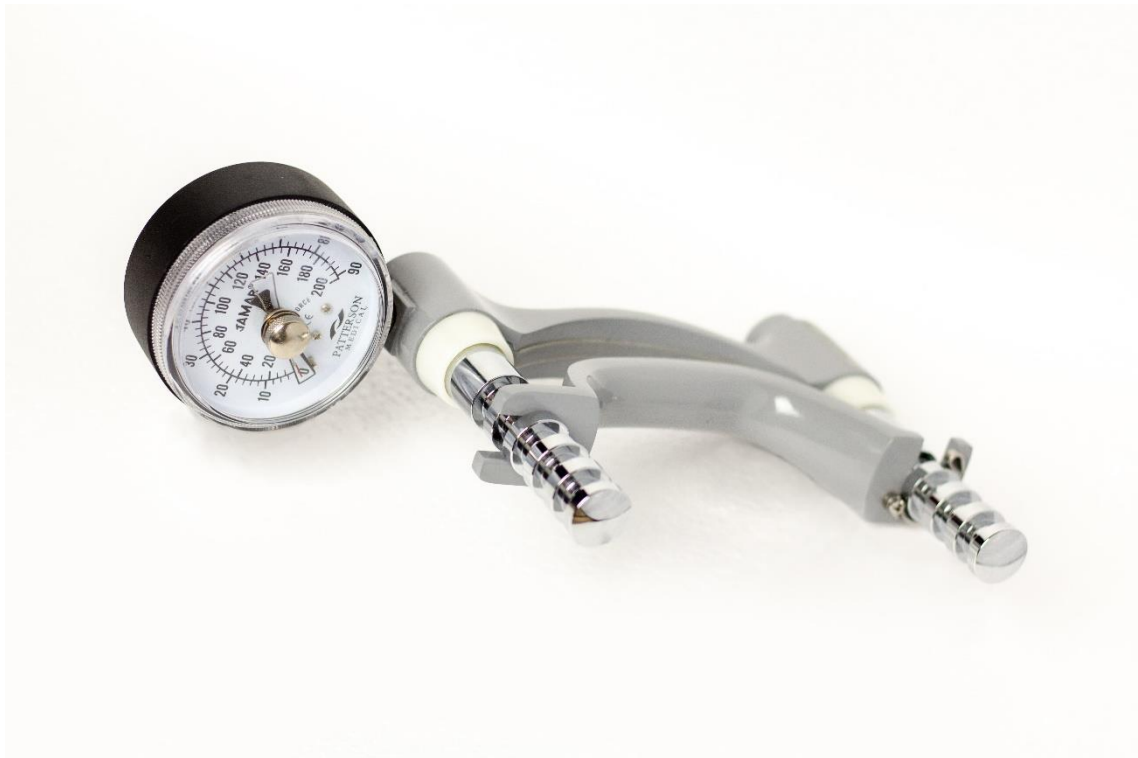
Rycina 2. Fotografia hydraulicznego dynamometru ręcznego JAMAR zastosowanego w badaniu [źródło własne autora]
