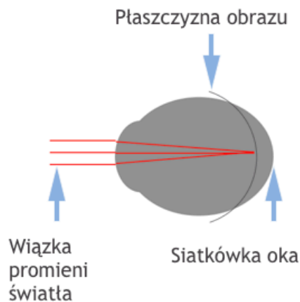
Rycina nr 1. Schemat oka krótkowzrocznego, promienie światła równoległe do osi widzenia skupiają się przed siatkówką oka.
