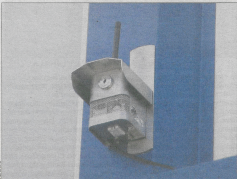
Urządzenie mierzy też temperaturę i wilgotność powietrza
