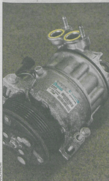
Kompresor – najdroższy element układu klimatyzacji
