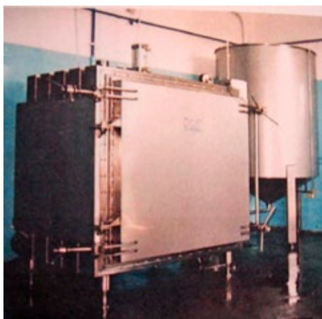
Urządzenie próżniowe do obróbki pieczarek WUA2
