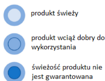
Rys. 4. Zasada działania wskaźnika TTI Fresh-Check, Lifeline
