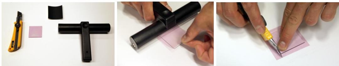
Figs. 55–57. Forberedelse av materialer. Fra venstre: et sett med grunnleggende verktøy, prosessen med å påføre et ark med fotopolymermateriale på en glassbase, trimming av overflødig film til ønsket størrelse.
