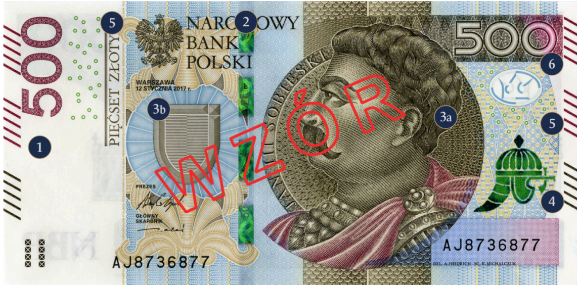
Fig. 3. En 500-zloty-seddel fra Den nasjonale banken i Polen, der et holografisk sikkerhetslement brukes — stripen markert med nummeret 2.
