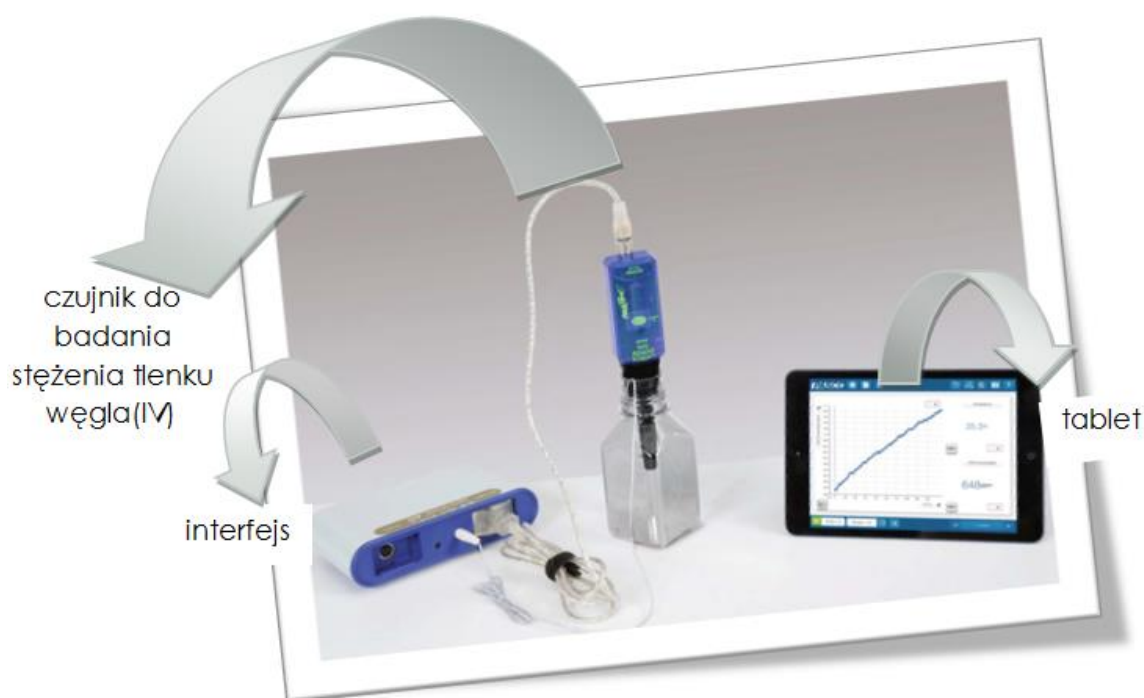
Zestaw przewodowych czujników PASCO z tabletem
