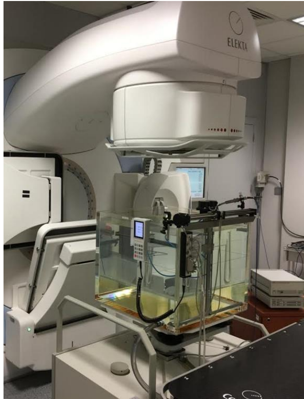
Rysunek 3.5.3.1. Zestaw pomiarowy z komorą jonizacyjną typu PinPoint 0,016 \text{ cm}^3 oraz fantomem wodnym PTW MP3.
