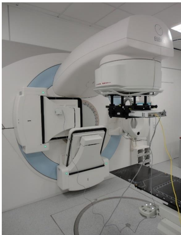
Rysunek 3.5.1.1. Zestaw pomiarowy Compass Dosimetry złożony z matrycy MatriXX Evolution oraz czujnika położenia gantry GAS.
