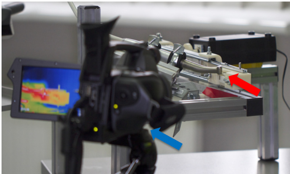
Rycina 7. Stanowisko badawcze. Na pierwszym planie widać kamerę termowizyjną (oznaczona strzałką niebieską), na drugim — statyw z układem skrawającym (oznaczone strzałką czerwoną). W układzie skrawającym widoczne jest wiertło przylegające do próbki tlenku cyrkonu (IV). Wiertło zostało zamontowane do unieruchomionej w statywie kątnicy przyspieszającej 1:5
