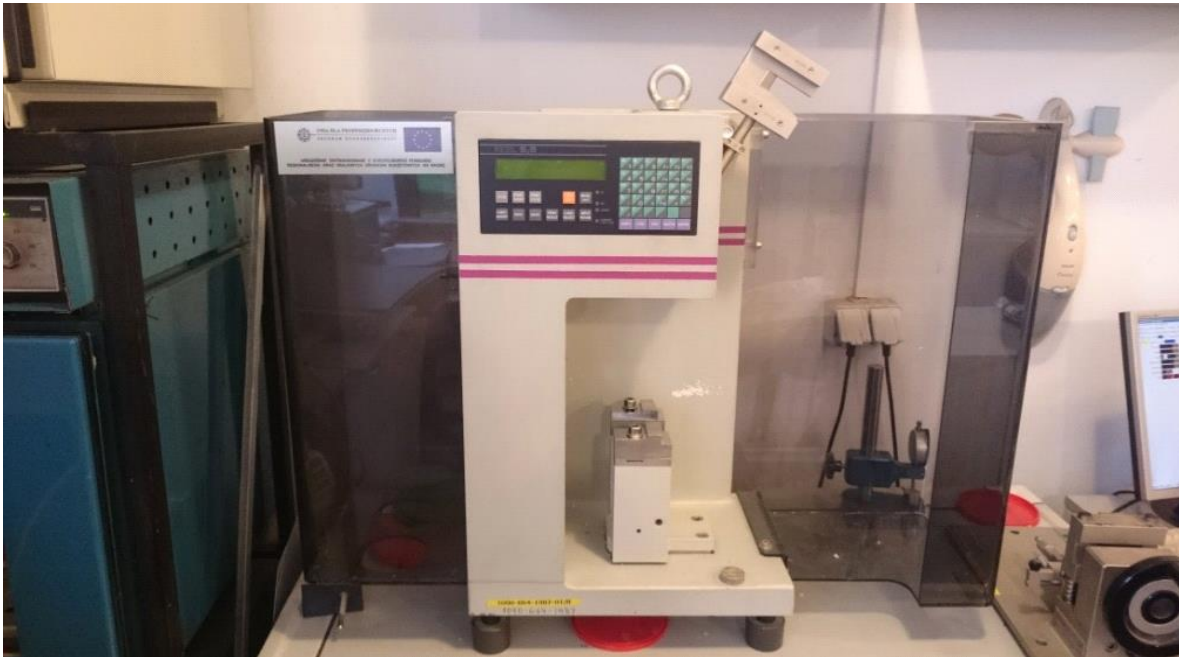
Ryc. 17. Młot wahadłowy typu Charpy'ego Ceast Resil 5.5J.
