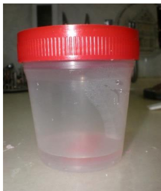
Ryc. 10. Próbkę w szczelnie zamkniętym pojemniku wypełnionym badanym roztworem substancji chemicznej.
