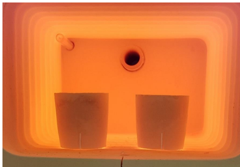
Ryc. 14. Wygrzewanie form odlewniczych z zaznaczonymi rysami orientacyjnymi (zbiory własne)
