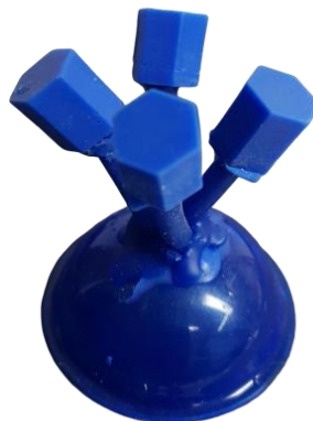
Ryc. 10. Formy silikonowe do wykonywania kostek z wosku odlewowego (zbiory własne)
