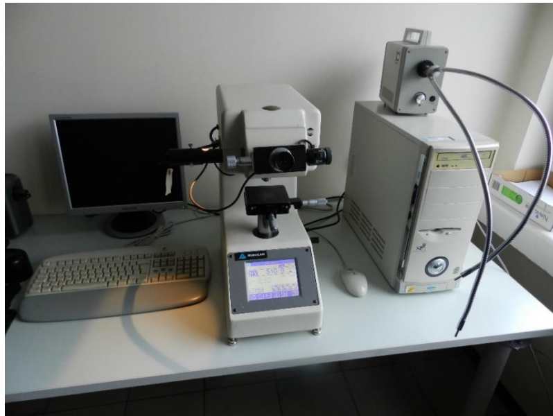
Ryc. 31. Urządzenie Mikromet na którym przeprowadzono pomiary twardości (zbiory własne)
