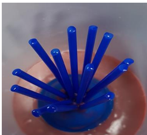
Ryc. 12. Druty woskowe umiejscowione na stożku odlewniczym (zbiory własne)
