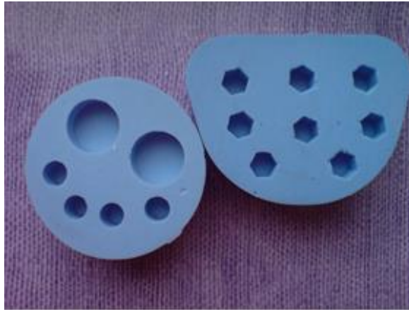
Ryc. 10. Formy silikonowe do wykonywania kostek z wosku odlewowego (zbiory własne)
