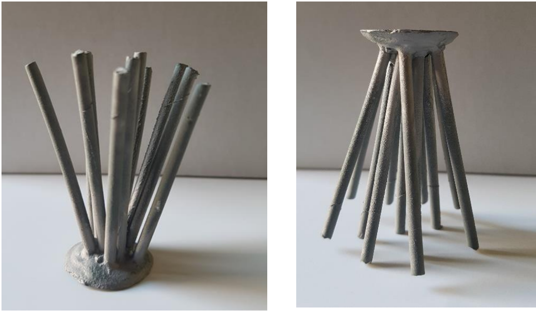
Ryc. 21. Oczyszczone z masy ogniotrwalej pręty metalowe po jednokrotnym topieniu (zbiory własne)
