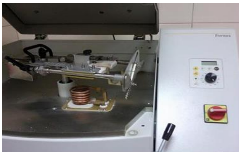
Ryc. 18. Odlewarka indukcyjna Bego Fornax T. (zbiory własne)
