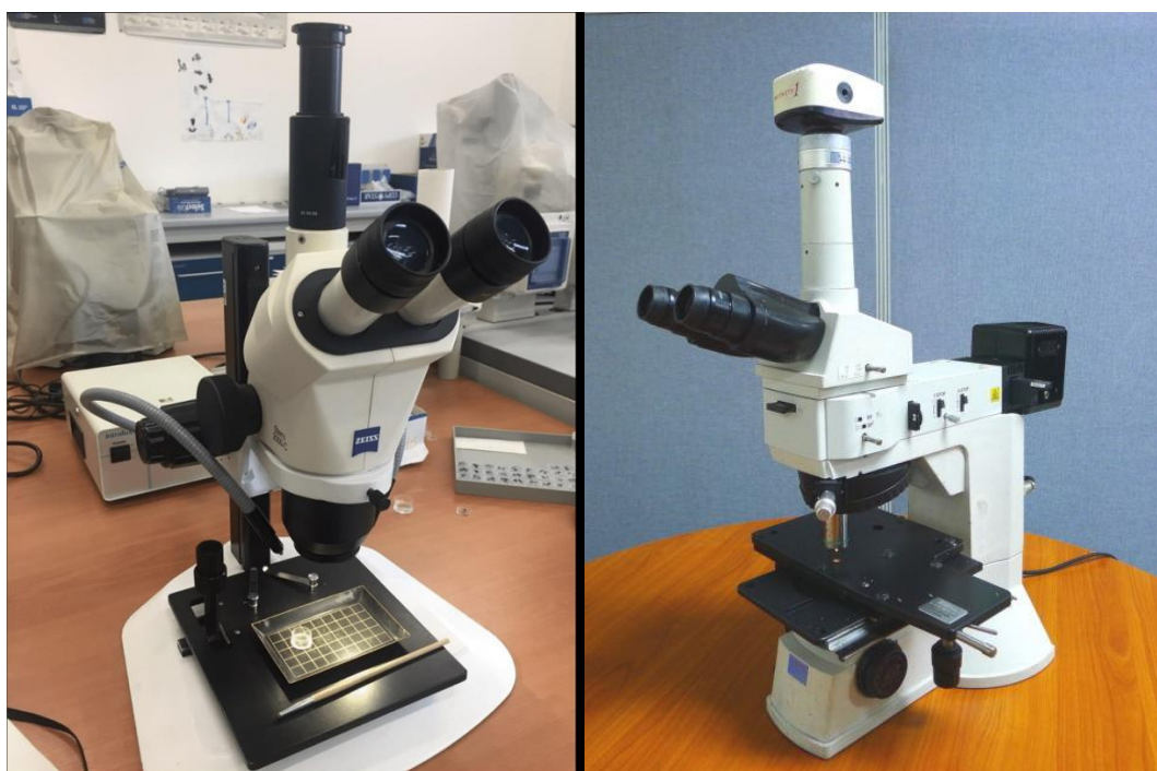
Ryc. 29. Mikroskopy Stemi2000C (Zeiss) i Eclipse L150 (Nikon) za pomocą, których wykonano obserwacje metalograficzne (zbiory własne)
