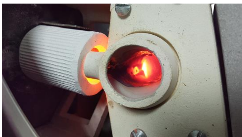
Ryc. 19. Wtłoczony dentystyczny stop chromowo kobaltowy do formy odlewniczej (zbiory własne)
