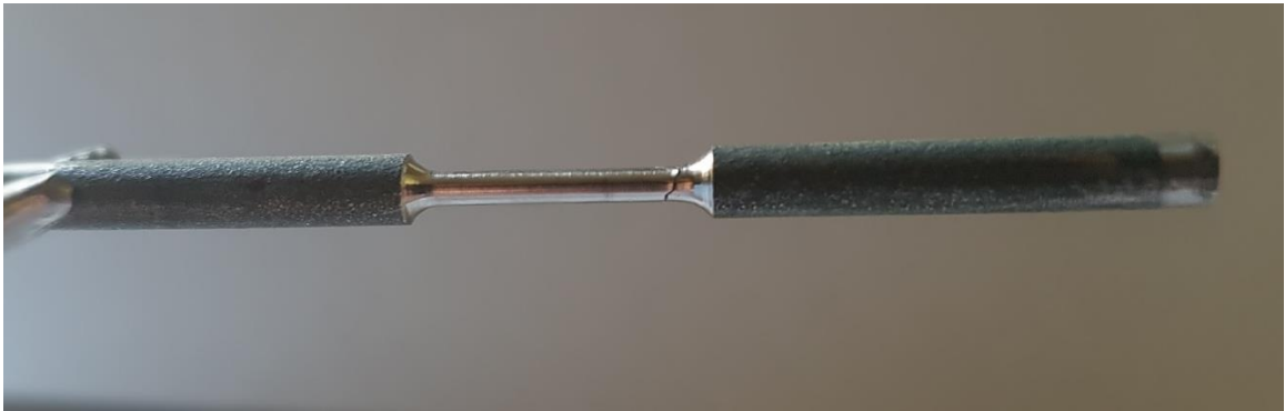
Ryc. 23. Gotowa próbka przygotowana do badań wytrzymałościowych (zbiory własne)
