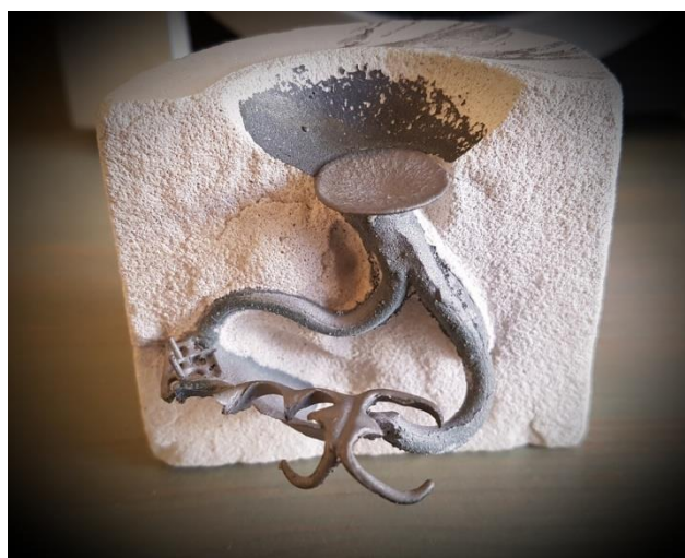
Ryc. 2. Odlana metalowa konstrukcja protezy szkieletowej w masie ogniotrwalej (zbiory własne)
