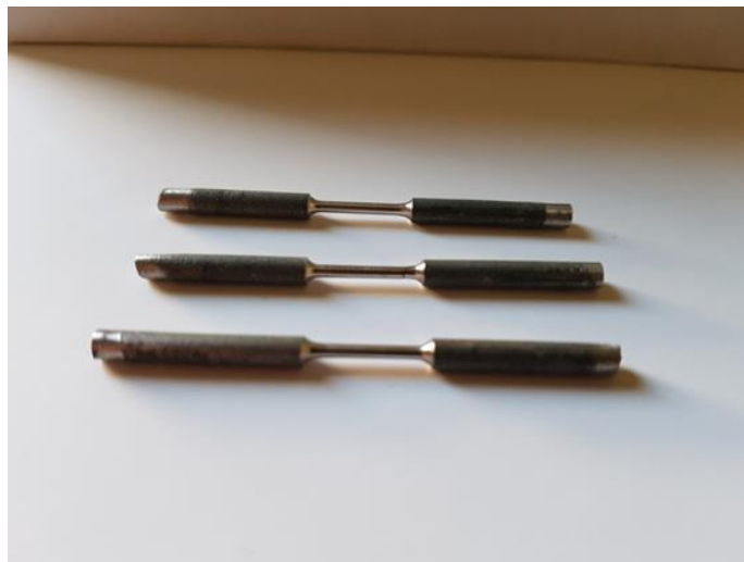
Ryc. 25. Próbkki przed wykonaniem testu na zrywanie (zbiory własne)
