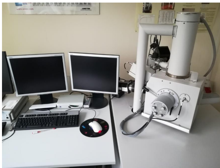
Ryc. 30. Mikroskop skaningowy Inspect S (FEI) wyposażony w mikroanalizator rentgenowski EDS (EDAX) (zbiory własne)
