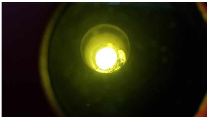
Rys. 17. Topienie dentystycznego stopu chromowo kobaltowego (zbiory własne)
