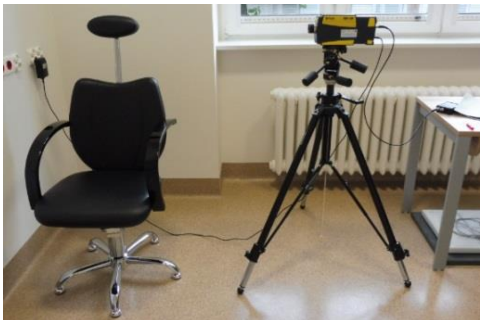
Ryc. 11. Układ pomiarowy do badań drgań stawów skroniowo-żuchwowych
