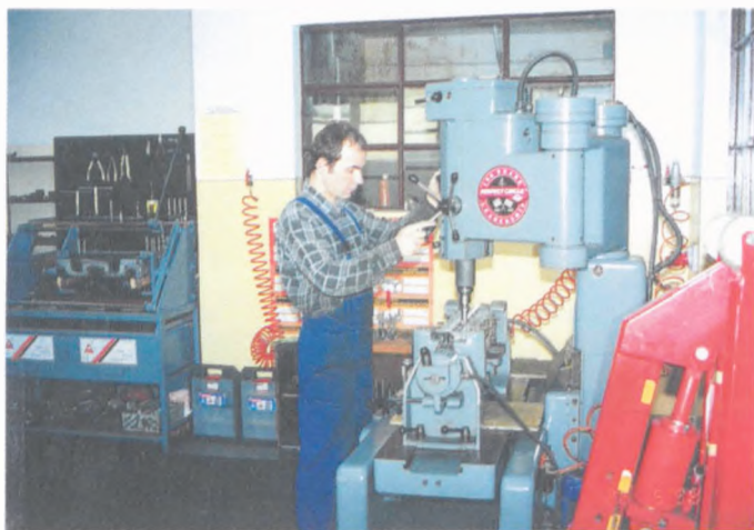
Obróbka głowic na nowoczesnej obrabiarce
