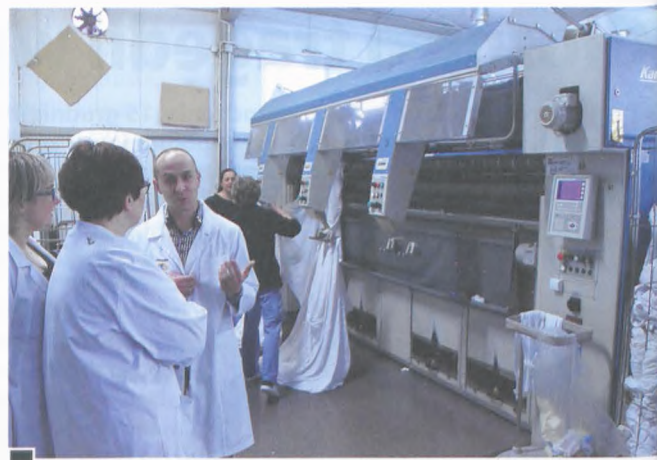
Stanowisko pracy Alony Romanenko – przednia część magła (tzw. podawarka) z chwytakami białej bielizny fot. Piotr P. Ruskowski
