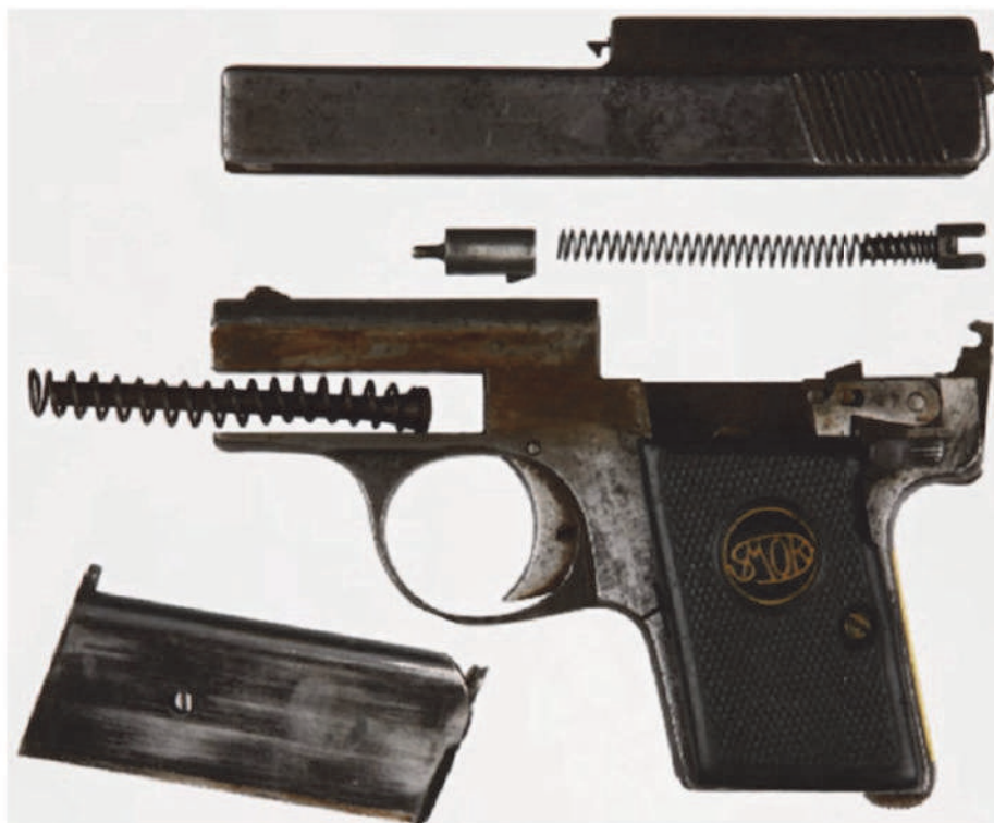
Zdjęcie pistoletu „Smok” rozłożonego na części. Foto: CLK Warszawa
