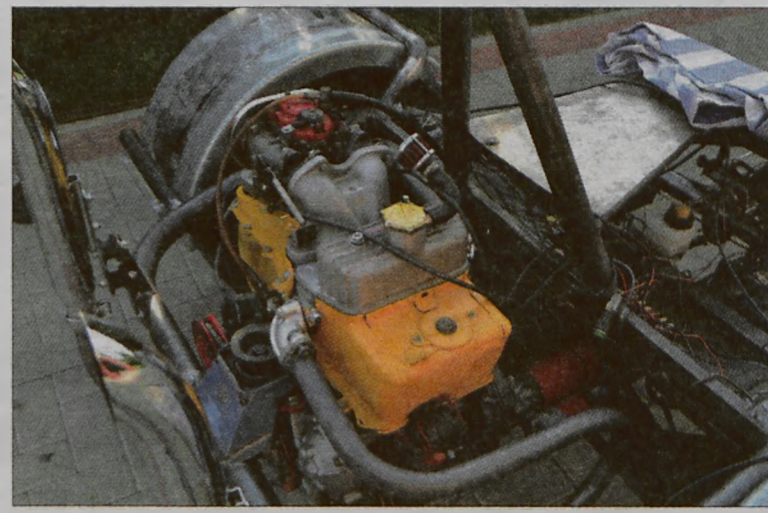
Silnik trójkołowca to prototyp fiata 126p, skonstruowany przez włoskich specjalistów od tuningu firmy Abarth.
