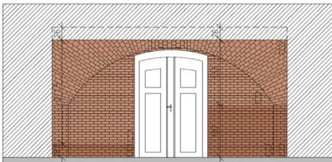
Il. 6. Sposób oznaczenia poszczególnych zakresów czynności przypisanych dla każdej ściany z osobna na przykładzie jednego z pomieszczeń piwnicznych ujętych w projekcie budowlanym Justyny Syller „Remont i renowacja murów wewnętrznych przyziemia Zamku w Kórniku” z 2019 roku.
