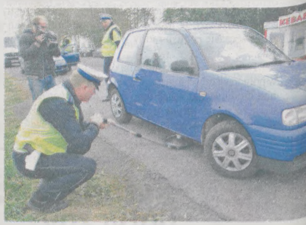
Specjalistycznym lustrem można skontrolować stan podwozia pojazdów
