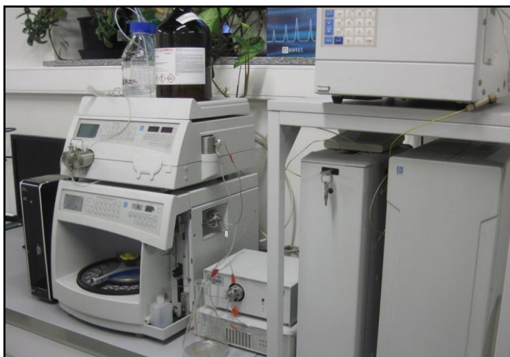
Ryc. 2. Chromatograf cieczowy z detektorem fluorescencyjnym
