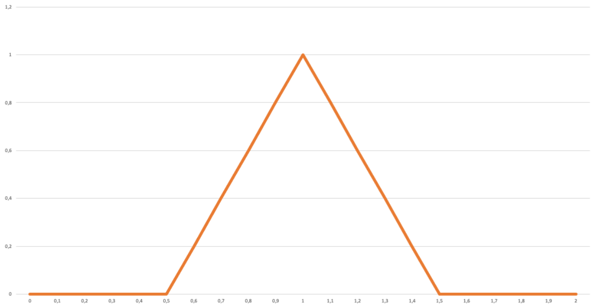
Rysunek 30. Trójkątna funkcja przynależności – przykład graficzny
