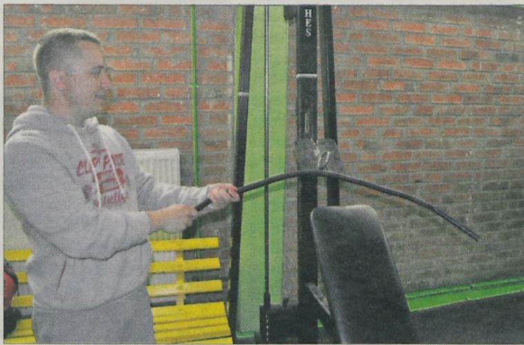
Gryfy przy maszynach są krzywe i w wielu miejscach pospawane...
