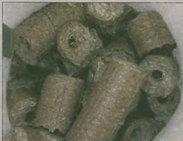
Brykiety - materiał opałowy ze sprasowanych pod wysokim ciśnieniem odpadów roślinnych (np. słomy, biomasy trawiastej).
