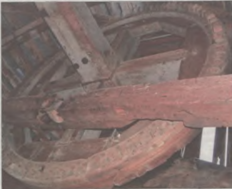
Choć wiatrak w Posoce nie ma już skrzydeł, to jego mechanizm, czyli potężne, drewniane koło, nadal jest na miejscu.
