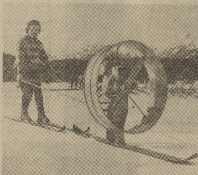
J. Nicklas z Oberammergau (NRF) skonstruował przyrząd mechaniczny do skijoringu, poruszany silnikiem. Osiąga on szybkość ok. 50 km/godz. Fot. CAF
