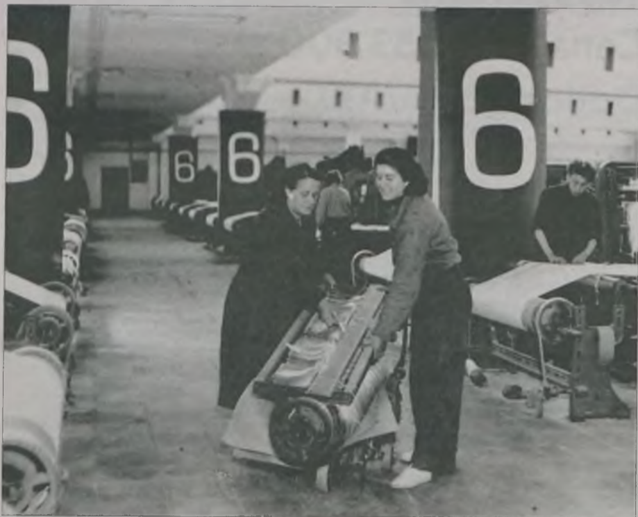
Prawdopodobnie 1955 r. - tkalnia starej „Mirandy” – zakładanie osnowy.
