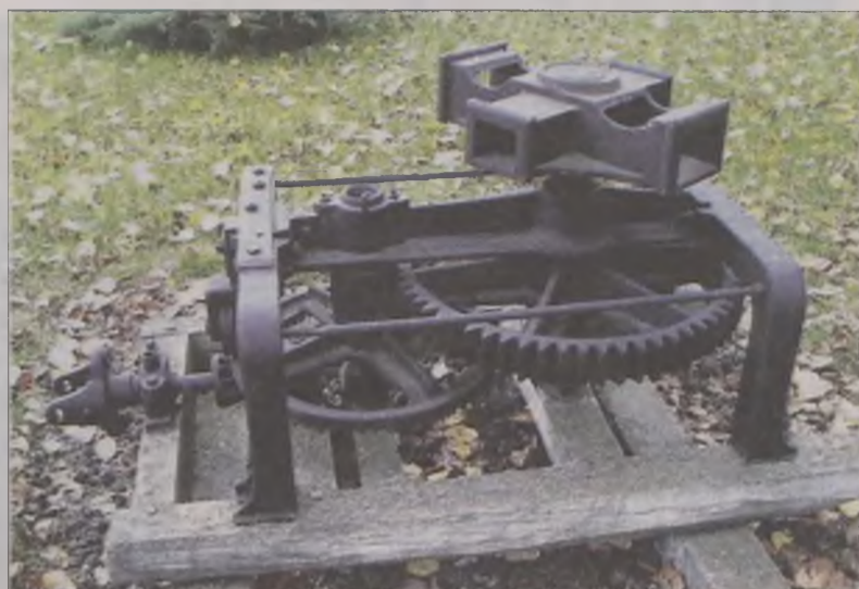
To właśnie maneż, inaczej kierat, czyli urządzenie wykorzystywane do napędu stacjonarnych maszyn rolniczych, np. młockarni, sieczkarni. Siłą napędową maneża były konie, czasami woły, zaprzęgnięte do drewnianych jego ramion.
