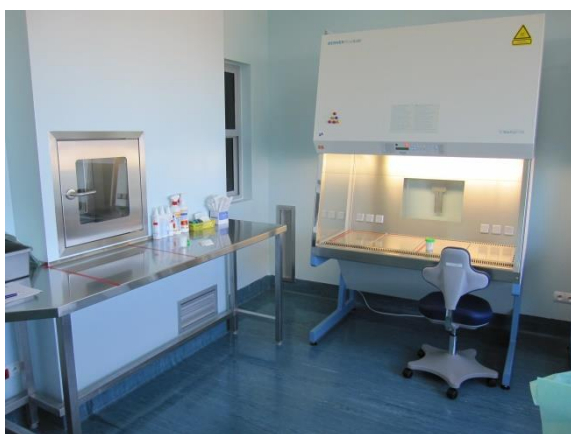
Rycina 19. Pomieszczenie czyste CPLC wyposażone w komorę laminarną z pionowym nawiewem powietrza.
