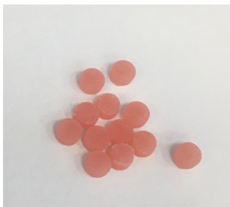
Ryc. 13. Próbki do badań sorpcji i DTS.
