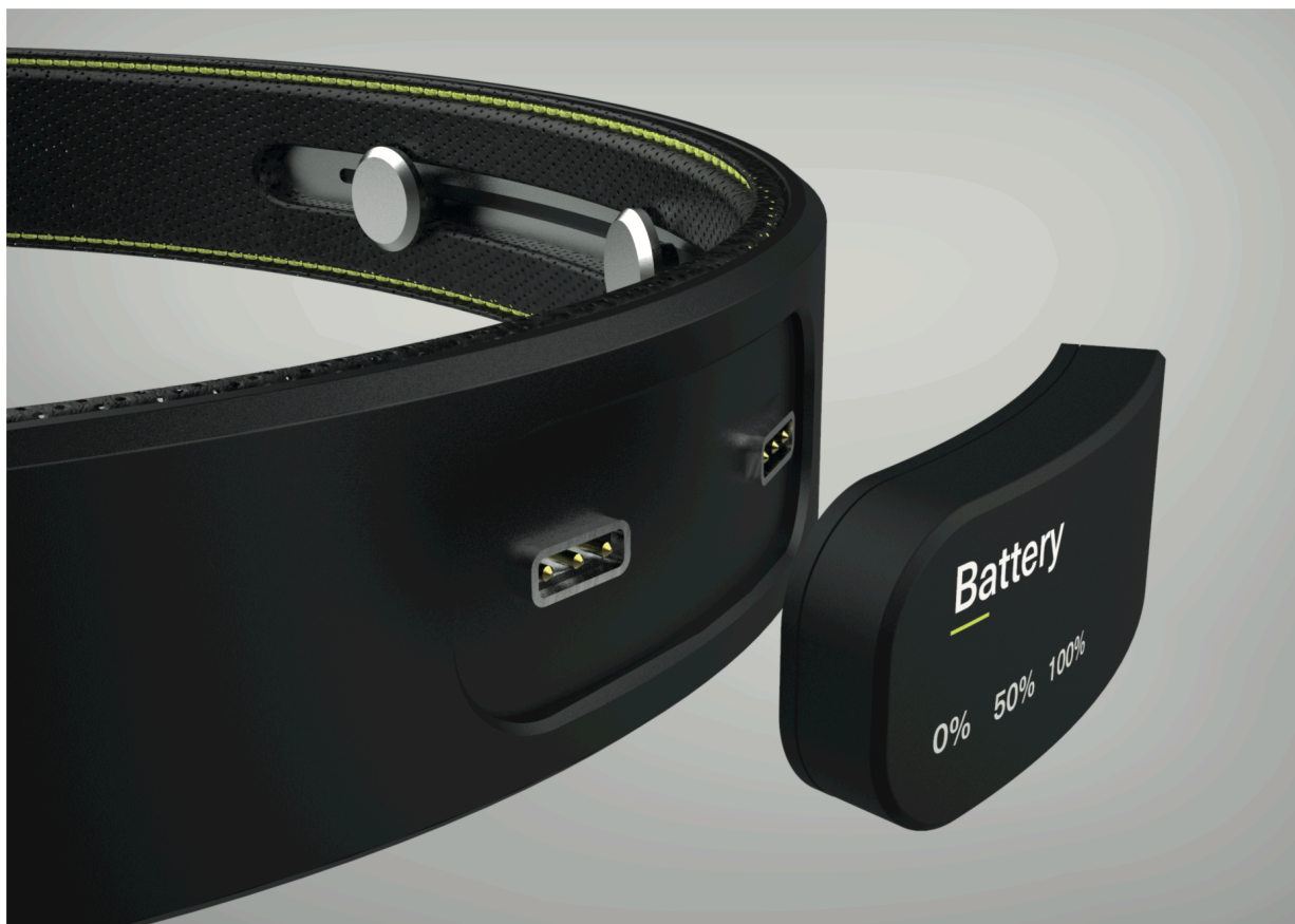
Rysunek 31. Pudełko z elektroniką oraz pierścień opaski - sposób montażu. Źródło własne.
