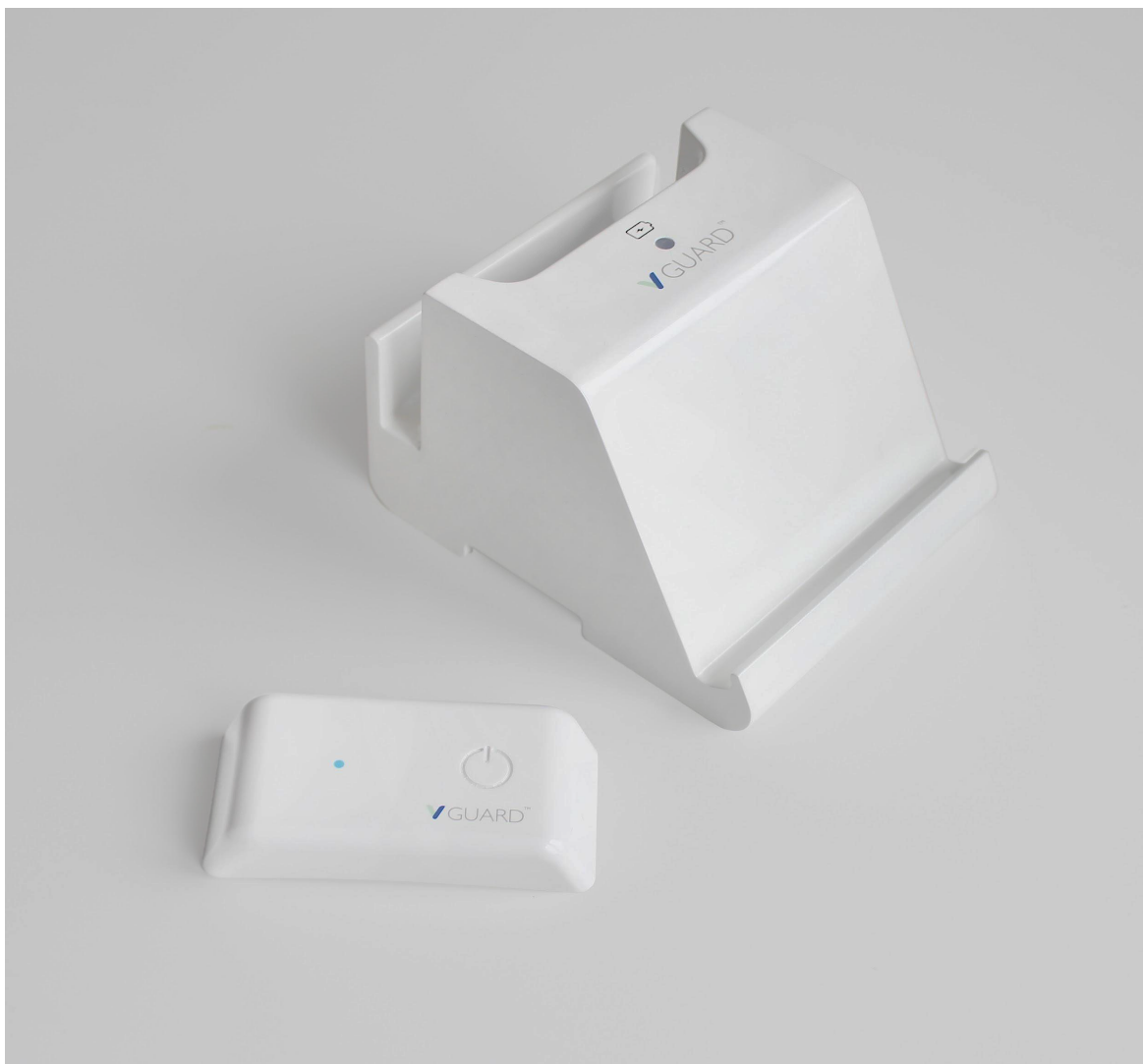
Rysunek 10. Ładowarka indukcyjna ze stacją dokującą na smartfona oraz pudełko z elektroniką urządzenia Vguard. Źródło: materiały własne
