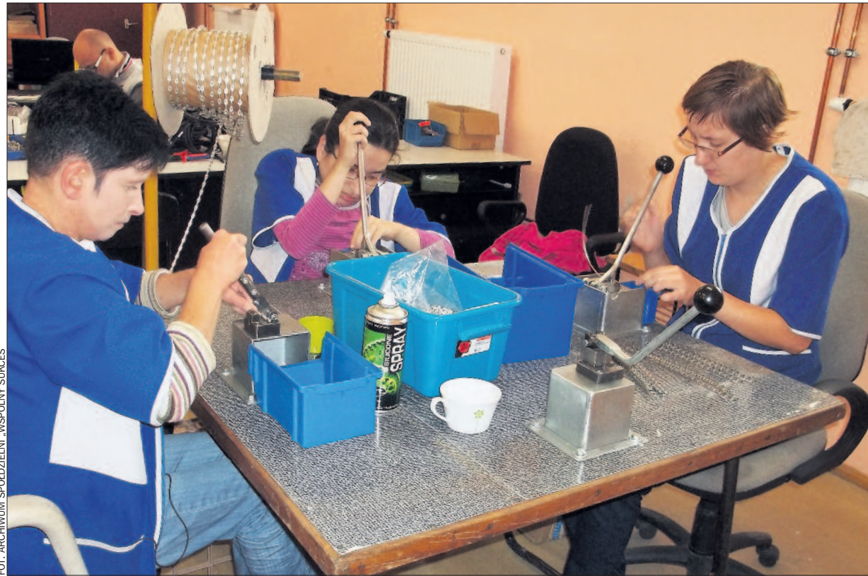
Pracownicy spółdzielni „Wspólny Sukces” z Wągrowca składają wiązki kablowe we współpracy z firmą El-Cab.
