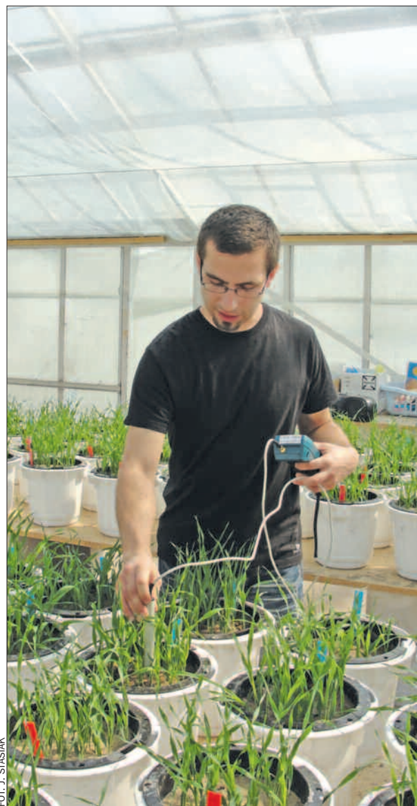
Pomiar wilgotności podłoża miernikiem typu FOM/mts.
