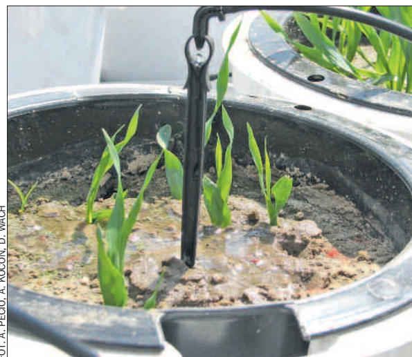
Dozowanie właściwej ilości wody za pomocą kapilarnego systemu automatycznej regulacji i monitoringu wilgotności gleby w wazonach typu GPI-SM300, sterowanego komputerowo.
