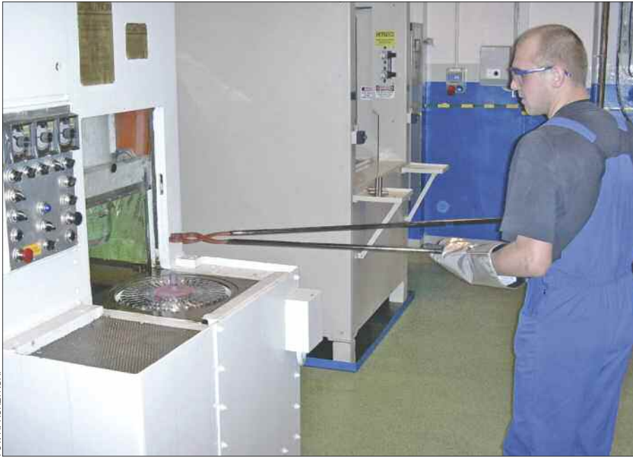
Hartowanie kół zębatych w zakładach Pratt & Whitney.
