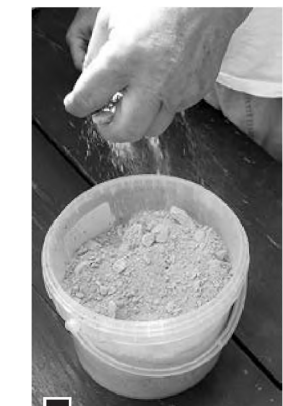
Materiał, którym, zdaniem pana Witolda, chciano wypełnić dziury w ul. Morelowej, udało mu się zabezpieczyć na potrzeby przyjrzenia się sprawie. Rozkruszone w palcach grudki zamieniają się w pył fot. Hanna Siatka
