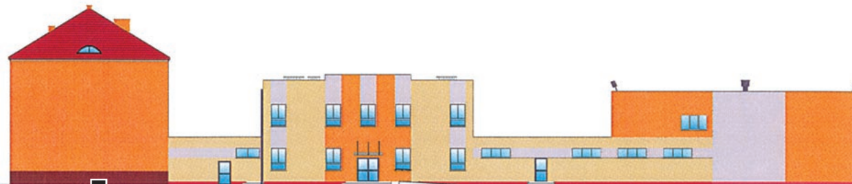
Elewacja kompleksu szkolnego SP 1 po rozbudowie, widok południowo-zachodni od strony ul. Szkolnej. Z lewej stary gmach SP 1, z prawej istniejąca sala gimnastyczna, w środku dodatkowy budynek dydaktyczny oraz jednokondygnacyjne łączniki na poziomie parteru oprac. Ekobud s.c.
