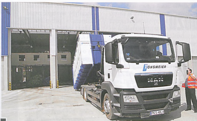
Odbiór jednej z frakcji śmieci, które przeszły przez system automatycznej selekcji. W hali w głębi widać boksy z wyselekcjonowanymi butelkami PET w kolorach niebieskim i zielonym. Powyżej w pomieszczeniu z oknami odbywa się ręczne odzyskiwanie odpadów przeznaczonych do wykorzystania, które spadają do odpowiednich boksów fot. Piotr P. Ruskowski
