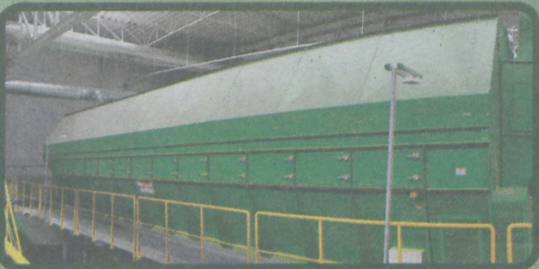
Sito bębnowe do wstępnego sortowania odpadów
