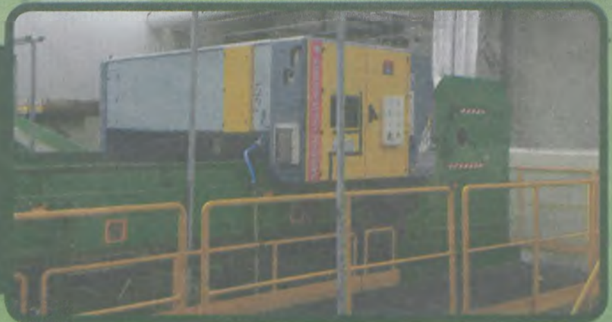
Separator opto-pneumatyczny do segregacji odpadów
