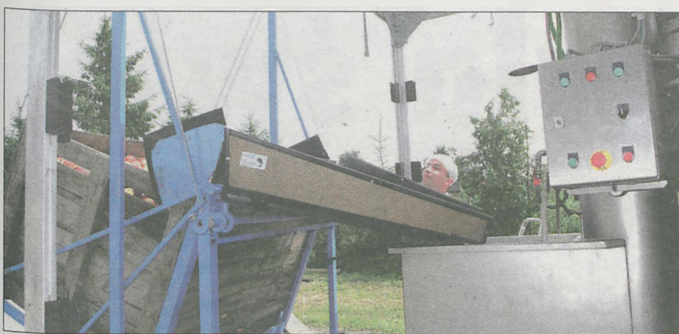
Owoce są przesypane do urządzenia myjąca-rozdrabniającego
