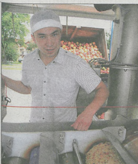
Owoce są przesypane do urządzenia myjąca-rozdrabniającego
