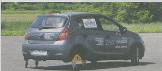
Prowadzenie auta po śliskiej nawierzchni nie należy do łatwych zadań. Co prawda lodu na placu nie było, ale w samochodzie zamiast kół z tyłu zamontowano małe kółeczka. Nawet przy najmniejszym ruchu kierownicą i nieumiejętnej kontrze – auto robiło piruety jak mistrz olimpijski w tańcu na lodzie. Dla większości kierowców była to bardzo pożyteczna lekcja radzenia sobie podczas poślizgu.
