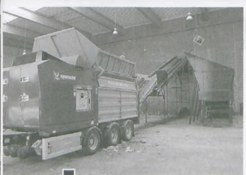
W hali przyjęć znajduje się mobilny rozdrabniacz wstępny, który rozrywa worki ze śmieciami i dzieli odpady o dużych gabarytach fot. Piotr P. Ruskowski
