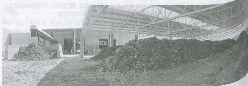
Kompostownia (po prawej), gdzie przez 6-8 tygodni dojrzewa środkowa frakcja w tzw. procesie stabilizacji. Pryzmy, w których zachodzą procesy biologiczne, gdzie powstaje temperatura ok. 70 stopni, są kilkakrotnie przesypywane. Posiadają specjalne odprowadzenie zanieczyszczeń płynnych oraz system przepuszczania powietrza o nieprzyjemnym zapachu przez filtr biologiczny z kory i rozdrobionych kawałków drewna fot. Piotr P. Ruskowski
