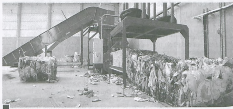
Specjalna prasa balotuje materiały o dużej kaloryczności, z których produkowane będzie paliwo alternatywne (substytut węgla) głównie dla przemysłu cementowego fot. Piotr P. Ruskowski
