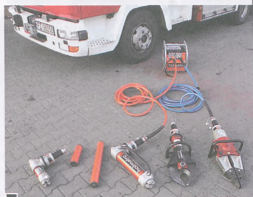
Nowa pompa hydrauliczna i specjalistyczny sprzęt fot. Norbert Kaźmierczak
