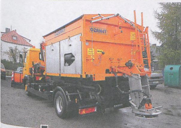
Z tyłu – zasobnik do piasku i soli z urządzeniem rozrzucającym fot. Paweł Jankowiak
