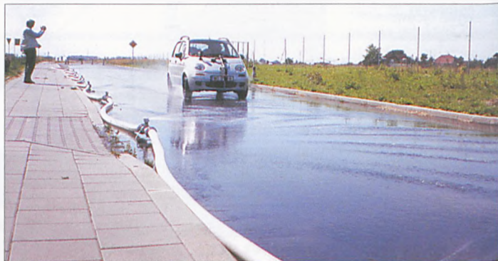
Specjalnie oprzyrządowane auto podczas testu na spryskiwanej drodze
