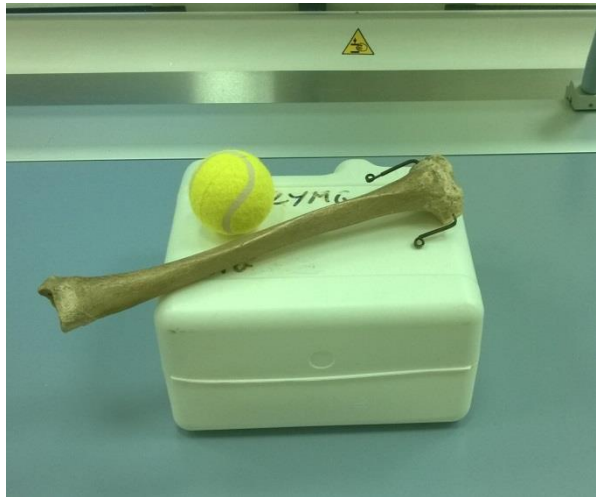
ZDJĘCIA 4.5, 4.6. Fantom wodny o grubości 13 cm z elementami pochłaniającymi promieniowanie X bardziej i mniej niż sąsiadujące otoczenie
