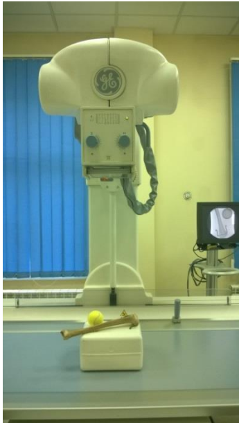
ZDJĘCIA 4.5, 4.6. Fantom wodny o grubości 13 cm z elementami pochłaniającymi promieniowanie X bardziej i mniej niż sąsiadujące otoczenie
