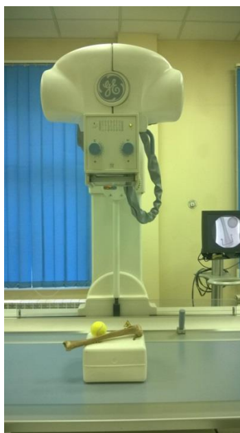
ZDJĘCIE 5.4. Fantom wodny o grubości 13 cm z kością piszczelową ludzką oraz piłką tenisową
