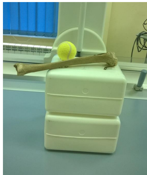
ZDJĘCIA 4.7, 4.8. Fantom wodny o grubości 26 cm z elementami pochłaniającymi promieniowanie X bardziej i mniej niż sąsiadujące otoczenie
