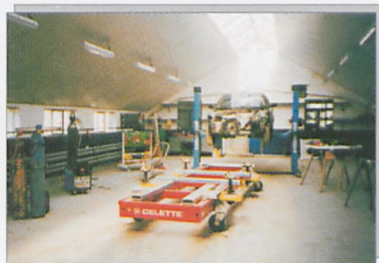
Hala blacharni z urządzeniami firmy CELETTE
