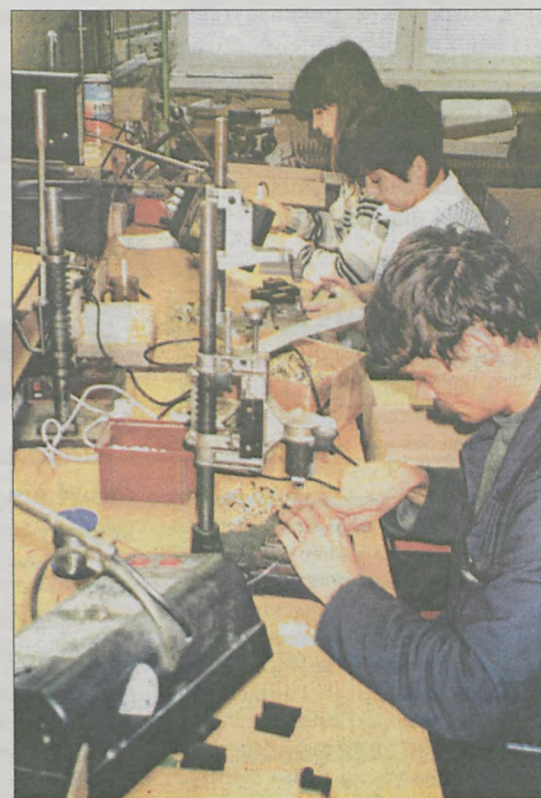
Montaż GCO (urządzenia, które steruje pracą pieca c.o. na gaz w domku jednorodzinny)
