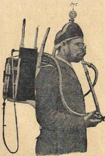
Aparatura Zuntza do badań przemiany materji w czasie chodu.
