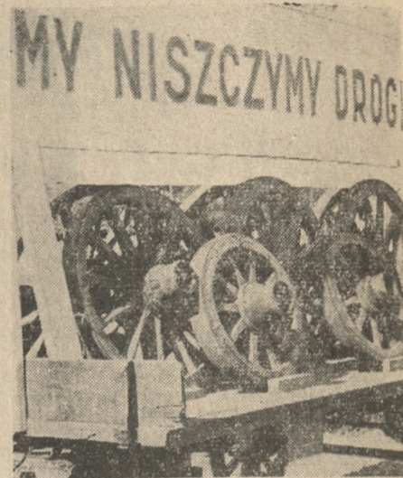
Warszawa wydała wojnę wozom o żelaznych obręczach i ostro podkutyim koniom, niszczącym gładkie nawierzchnie ulic i wywołującym wielki hałas. W tym celu prowadzi się kampanię propagandową za ogumianiem kół u wozów. Oto wóz propagandowy: nad kołami o żelaznych obręczach umieszczono wymowny napis: „My niszczymy drogi!” Fot. J. Ryś
